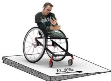
Рис. 6. Предельно допустимые значения поперечного уклона
