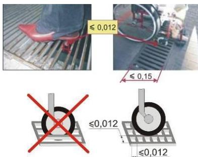
Рис. 48. Примеры конструкции решеток ливневой канализации
