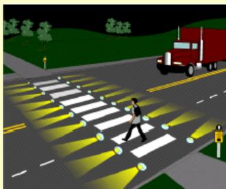
Рис. 140. Пример маячков с внутренним источником света на пешеходном переходе
