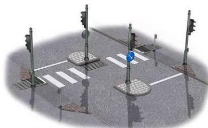
Рис. 132. Пример разделения тактильных наземных указателей и пандусов
