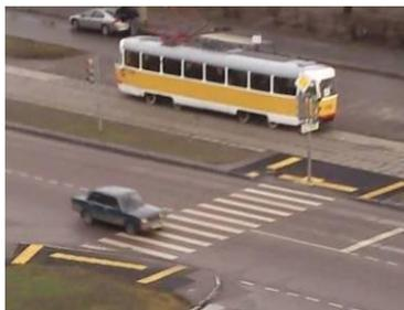
Рис. 127. Пример размещения стандартных тактильных наземных указателей перед пешеходным переходом (Москва)
