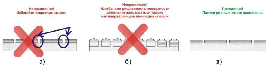
Рис. 20. Примеры неправильной (а, б) и правильной (в) формы поверхности покрытия объектов пешеходной инфраструктуры [67]
