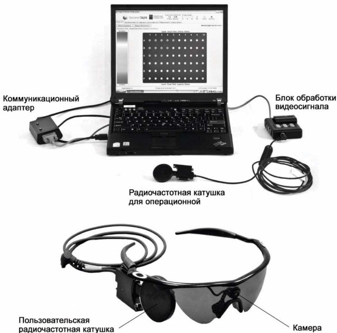
Рисунок 1. Внешняя часть ретиальной протезной системы ArgusII
