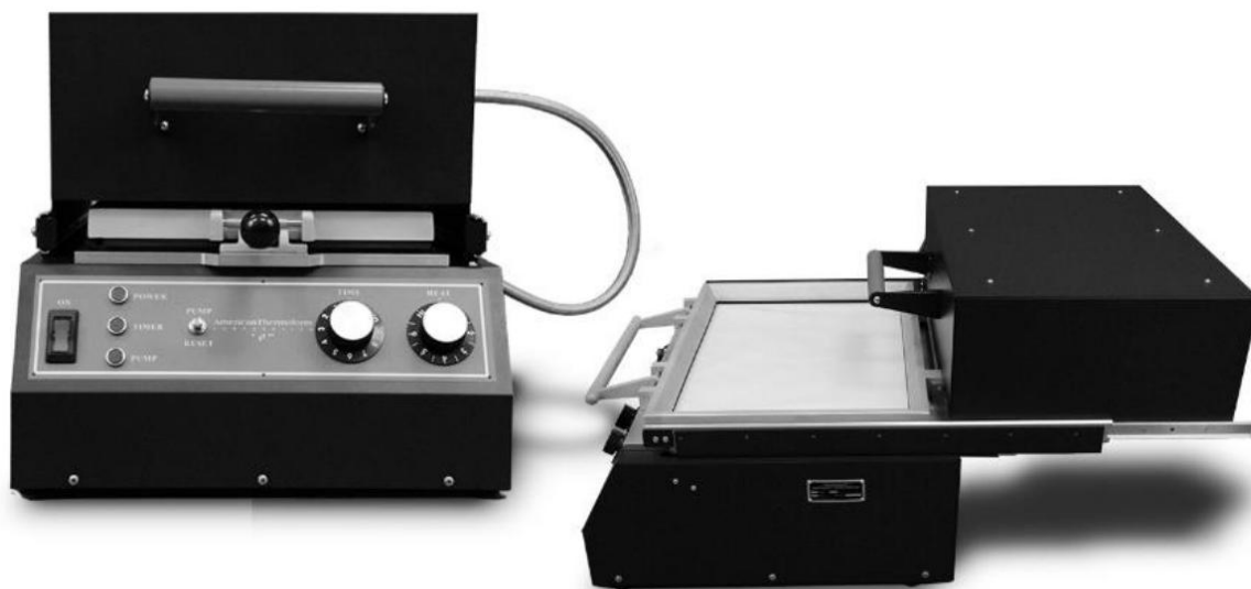
Рис. 4. Портативное устройство для термоформования.
